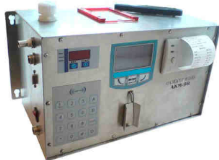
Рисунок 10.1 – Моделі молочної міні-лабораторії серії АКМ-98: a – «Фермер»; b – «Станція»
